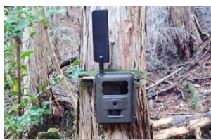
IoTセンサーカメラを設置 (画像をリアルタイムでスマホに送信)
