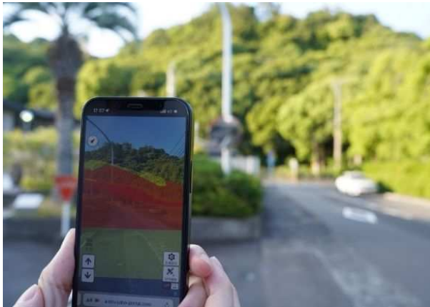
土砂災害警戒区域等のAR表示
