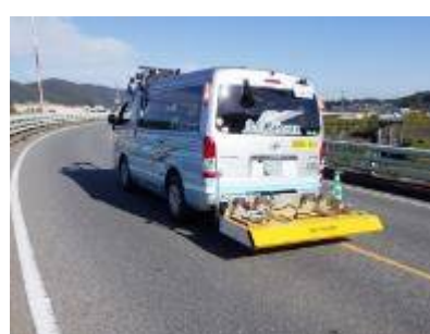
床版点検車による点検（委託）
