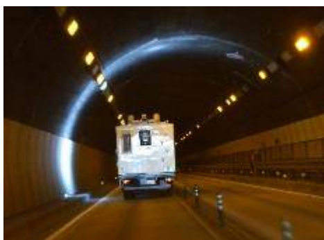
図Ⅲ-7 走行計測車両による覆工画像撮影状況
