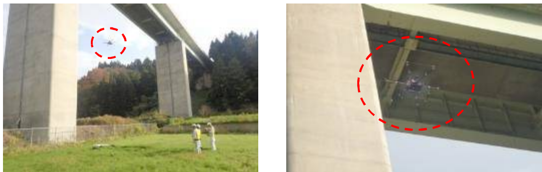
図Ⅱ-9 ドローンによる点検状況
