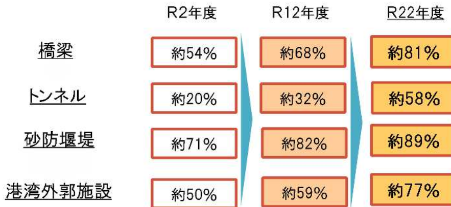
図1.11 建設後50年以上経過する施設の割合
