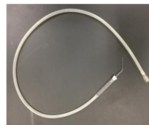
図 13 吸引用手製ピペット
